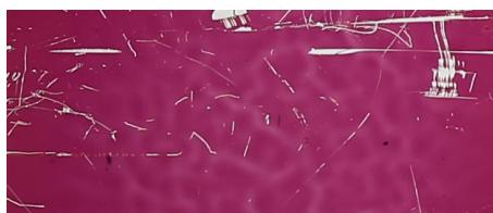
Abbildung 1: Inhomogenitäten und Kratzer auf einer gedruckten Solarzelle
